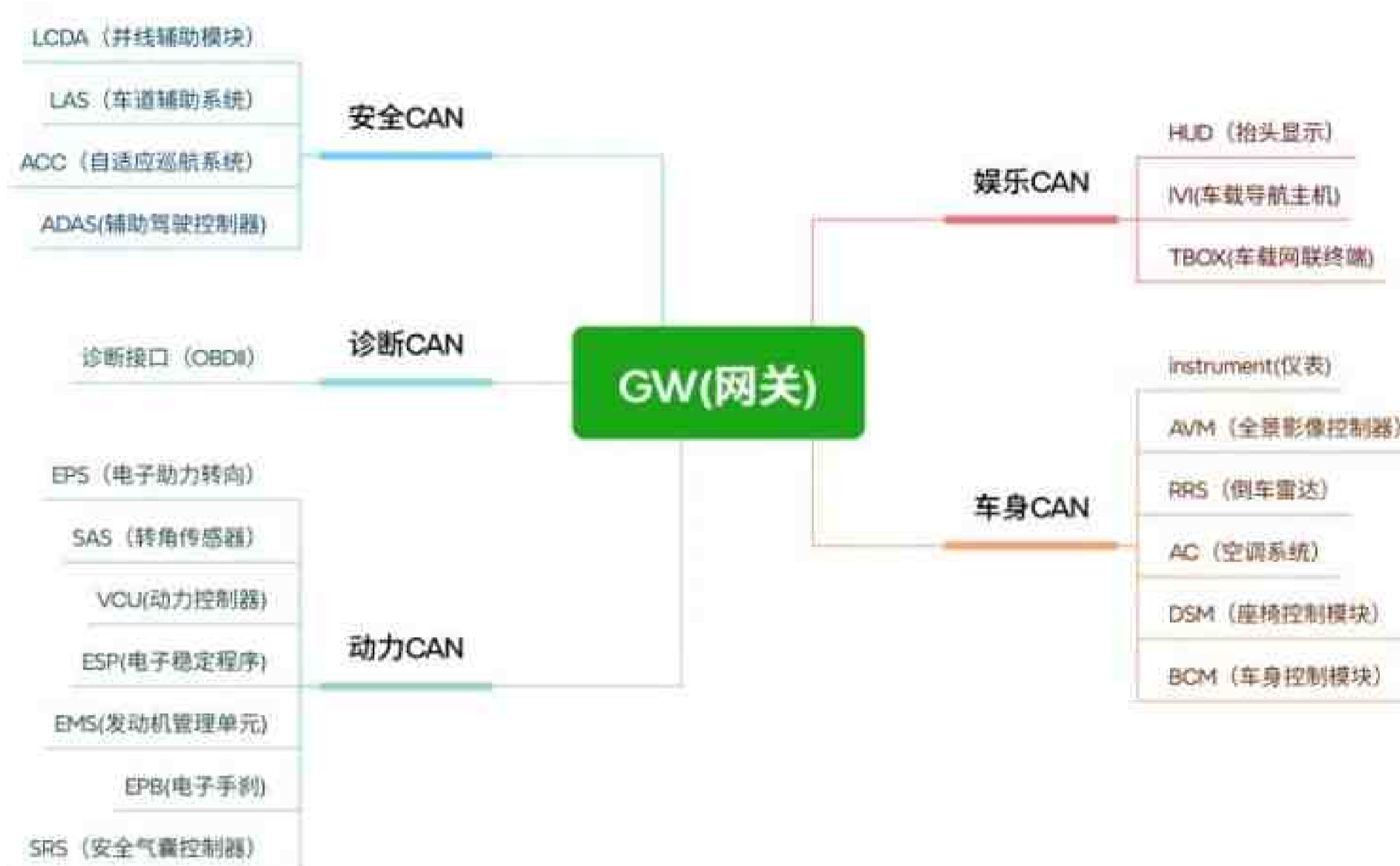
图 2.1 汽车 CAN 网络域架构示例
